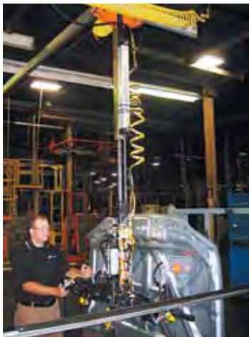
Tubo de torsión con dispositivo de manipulación de vacío integrado
